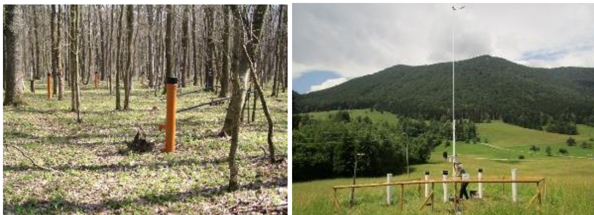
Slika 53: Prikaz vzorčevalnikov za usedline na ploskvah intenzivnega spremljanja gozdnih ekosistemov znotraj sestoja (levo, foto: M. Rupel) in na odprtem (desno, foto: I. Sinjur).
