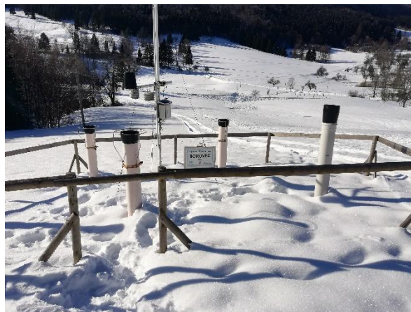
Slika 74: Ploskev Borovec: nameščanje novih pokrovov za lizimetske svečke oz. stekleničke s talno raztopino (levo) in meteorološka postaja Borovec pozimi, kjer je bil obnovljen nosilec za spremljanje pasivnega ozona s termometrom (desno) (Foto: M. Rupel).
