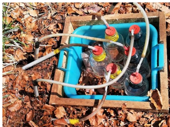
Slika 72: Ploskev Fondek: ureditev dostopne vlake po pravilu lesa (levo) popravljeni oz. zamenjani poškodovani lizimetri (desno) (Foto: M. Rupel).
