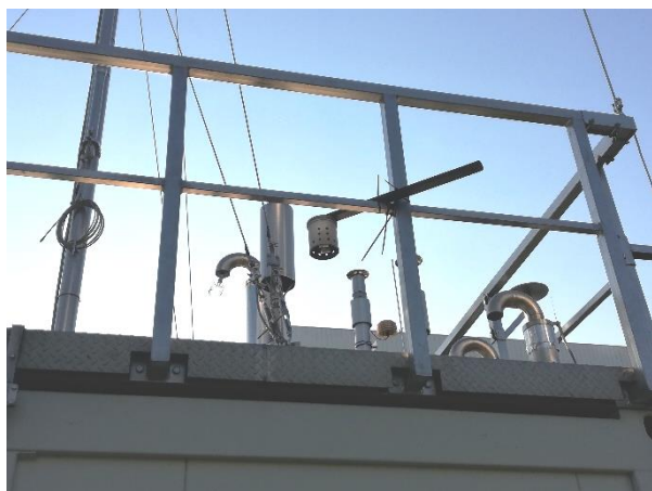
Slika 61 (zgoraj in desno): Kontrolne meritve ozona z difuzivnimi vzorčevalniki na novi merilni postaji ARSO v Ljubljani (avgust 2021) (Foto: M. Rupel).
