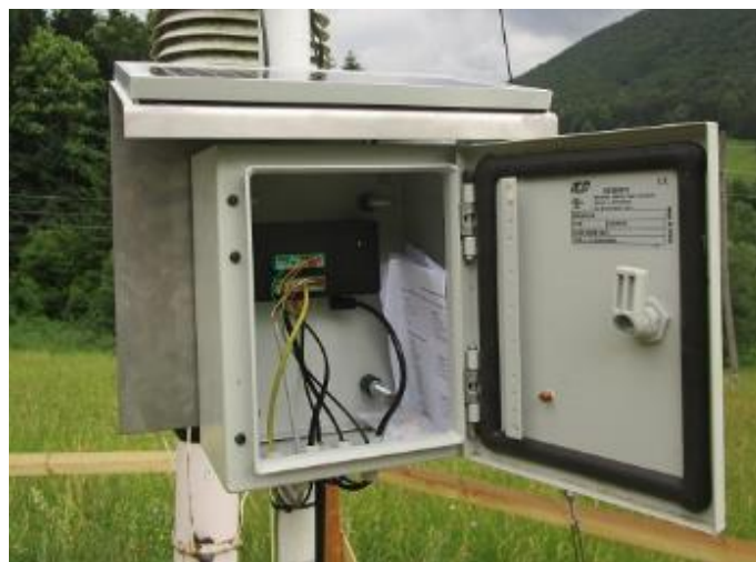
Slika 52: Omarica s sončno celico, Li-Ion baterijo, anteno, GPRS modemom in hranilnikom podatkov (Foto: I. Sinjur)
