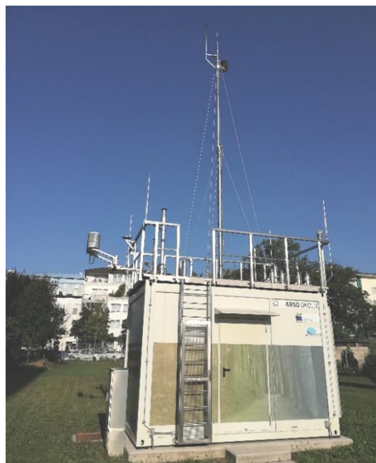
Slika 61 (zgoraj in desno): Kontrolne meritve ozona z difuzivnimi vzorčevalniki na novi merilni postaji ARSO v Ljubljani (avgust 2021) (Foto: M. Rupel).
