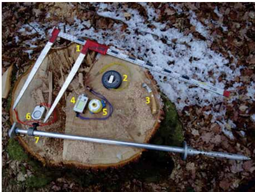
Terenska oprema za izmero dendrometrijskih parametrov: 1 premerka, 2 merski trak (pi-meter), 3 zadirač, 4 razdaljemer in višinomer, 5 sprejemnik (tarča) razdaljemera, 6 busola, 7 stativ za busolo.
