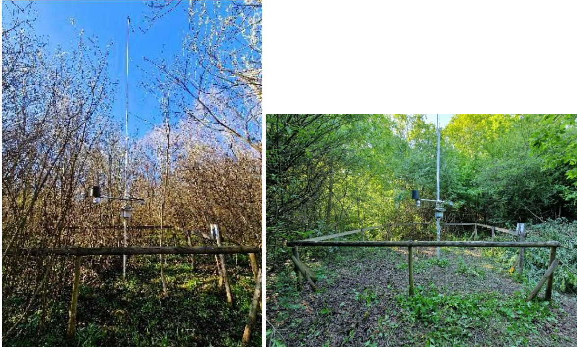
Slika 119: Meteorološka postaja Krakovski gozd pred in po izvedenih vzdrževalnih delih – stanje ob ponovni zaraščeni (marec 2025) ter po obžagovanju in odstranitvi drevja (maj 2025). (Foto: A. Kavčič).
