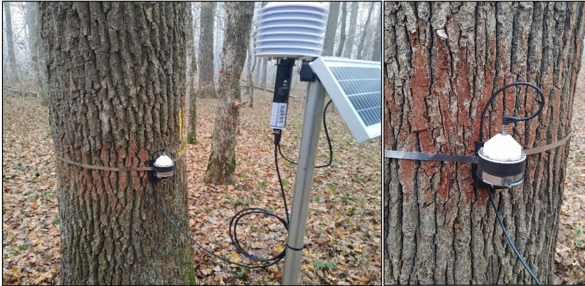
Slika 41: Tipična instalacija enega merilnega mesta z elektronskim dendrometrom, zbiralnikom podatkov in različnimi okoljskimi senzorji. Senzorji za vsebnost vode v tleh in temperaturo tal na 30 cm niso vidni, ker so zakopani v tla.
