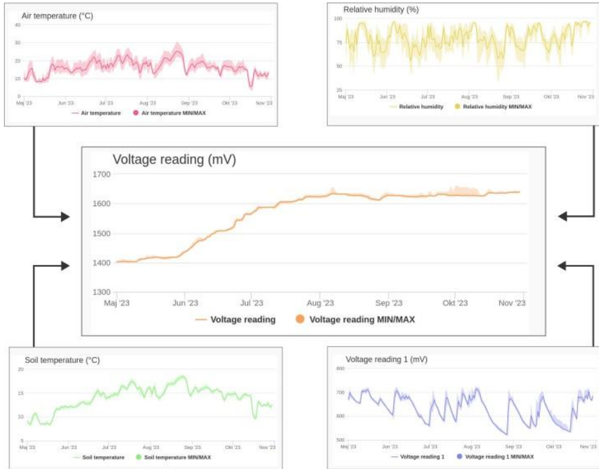
Slika 42: Meritve sezonske priraščanja dreves z elektronskimi dendrometri ter »spremljajoči podatki«. V sredini se nahaja graf debelinskega priraščanja v letu 2023 merjen z elektronskim dendrometrom, zgoraj in spodaj pa so prikazani »spremljajoči podatki« - temperatura zraka, relativna zračna vlažnost, temperatura tal na globini 30 cm in vsebnost vode v tleh na globini 30 cm.
