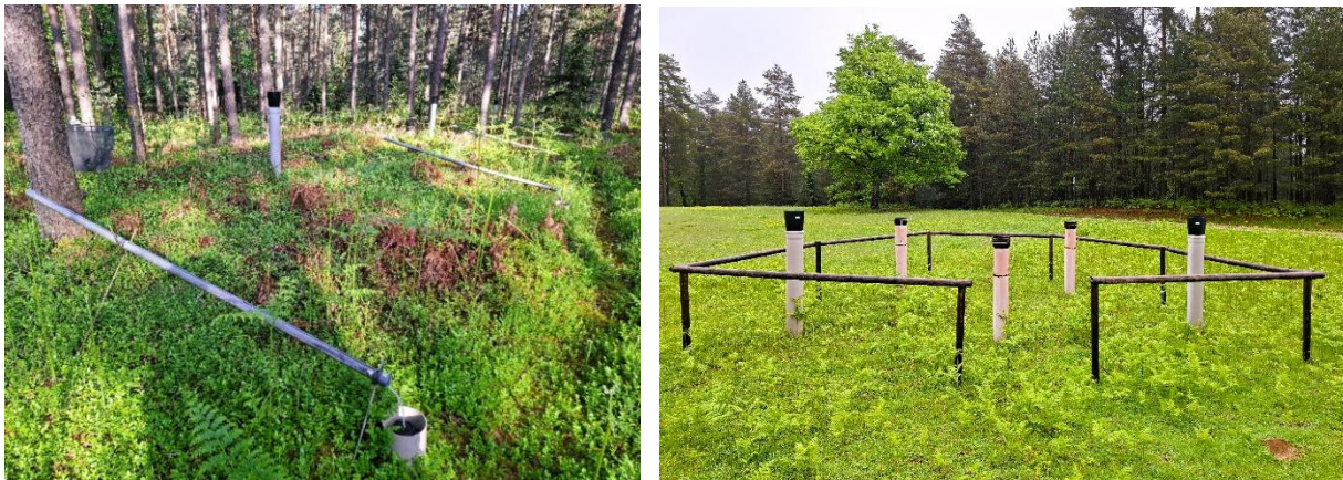
Slika 71: Prikaz vzorčevalnikov za usedline na ploskvah intenzivnega spremljanja gozdnih ekosistemov znotraj sestoja (levo) in na odprtem (desno) (Foto: M. Rupel)
