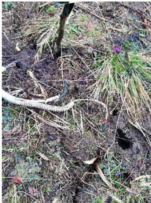
Slika 100: Divje svinje so nekajkrat razkopale območje kontrolne ploskve Petinove jame ter uničile senzorce meteorološke postaje, ki so zakopani v tleh. (Foto: M. Rupel)
