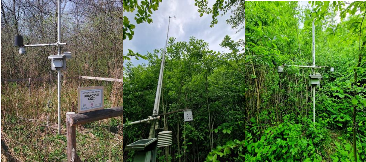
Slika 99: Okolica meteorološke in merilne postaje Krakovski gozd za spremljanje ozona se je zelo zarasla (sredina in desno). Potrebno bo čiščenje bližnje okolice. Levo je stanje v letu 2020. (Foto: levo M. Rupel; sredina in desno A. Kavčič)
