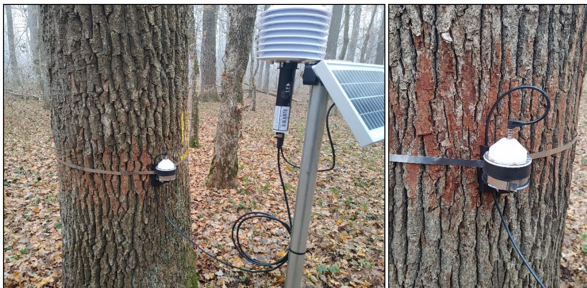
Slika 40: Tipična instalacija enega merilnega mesta z elektronskim dendrometrom, zbiralnikom podatkov in različnimi okoljskimi senzorji. Senzorji za vsebnost vode v tleh in temperaturo tal na 30 cm niso vidni, ker so zakopani v tla.
