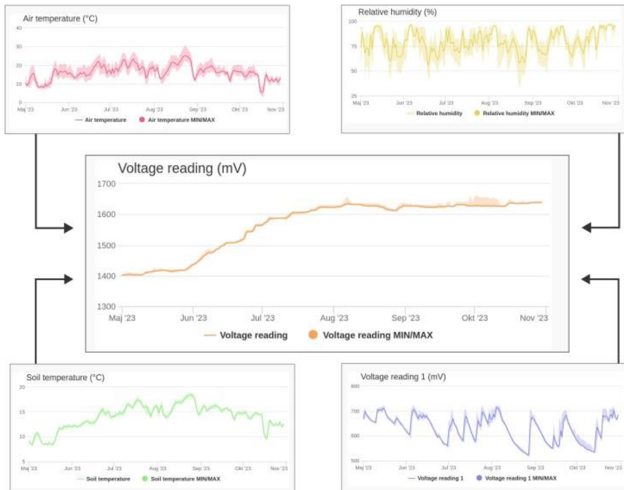
Slika 41: Meritve sezonskega priraščanja dreves z elektronskimi dendrometri ter »spremljajoči podatki«. V sredini se nahaja graf debelinskega priraščanja v letu 2023 merjen z elektronskim dendrometrom, zgoraj in spodaj pa so prikazani »spremljajoči podatki« - temperatura zraka, relativna zračna vlažnost, temperatura tal na globini 30 cm in vsebnost vode v tleh na globini 30 cm.
